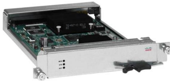
Figure 39 Contrôleur Nexus 9500 series<sup>64</sup>
