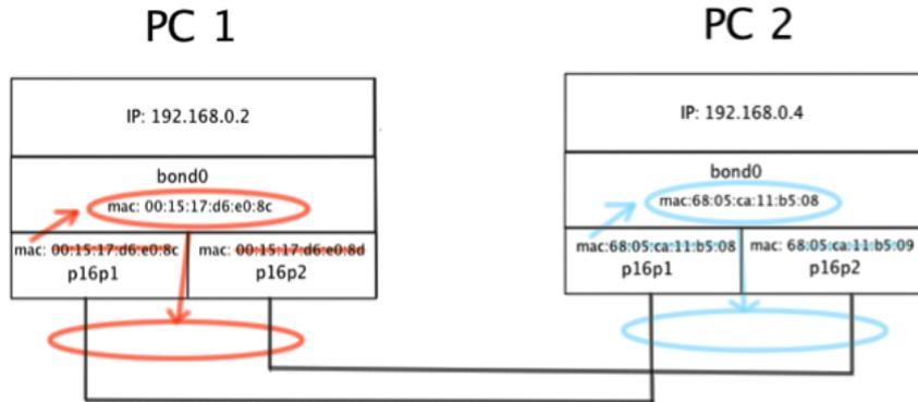
Figure 7: Schéma de principe mode 0
