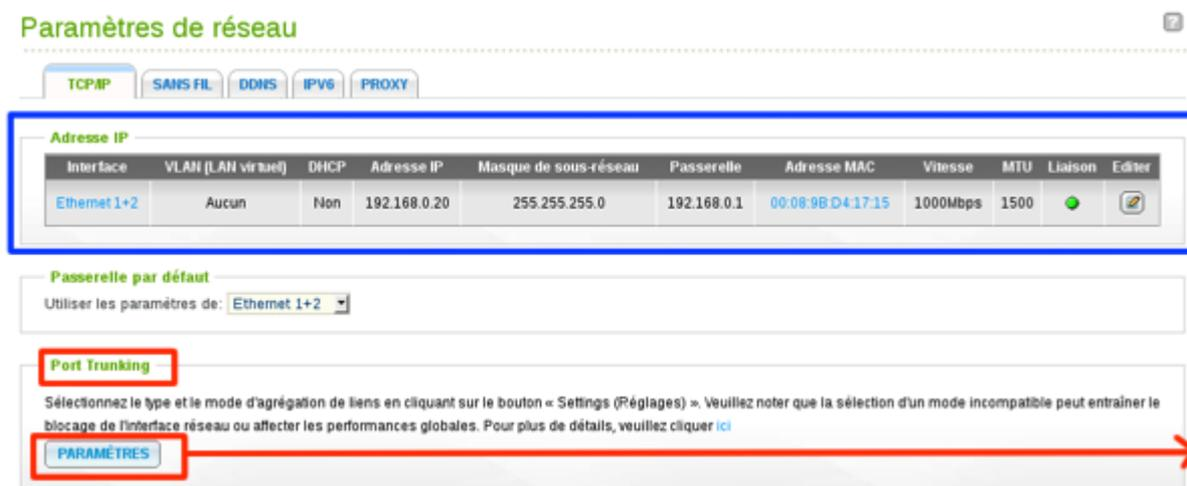
Figure 33: Activation bonding sur QNAP
